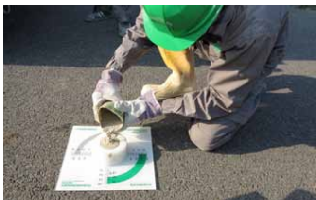
4 Zkouška rozlivu litého potěru
