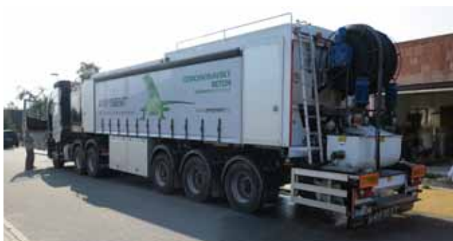
■ ANHYMENT® - mobilní výrobní zařízení na stavbě
