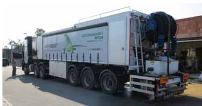
■ ANHYMENT® - mobilní výrobní zařízení na stavbě
