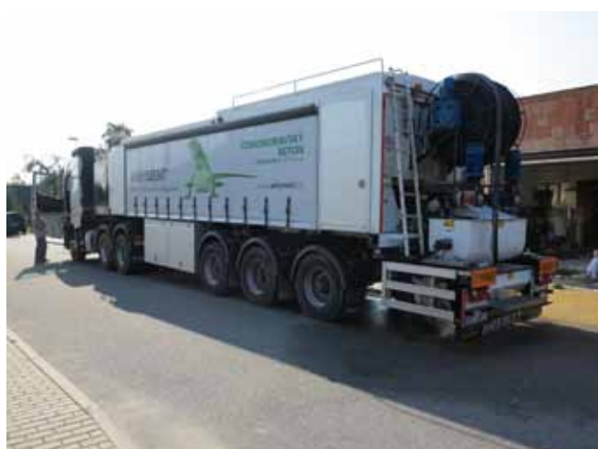
■ ANHYMENT® - mobilní výrobní zařízení na stavbě
